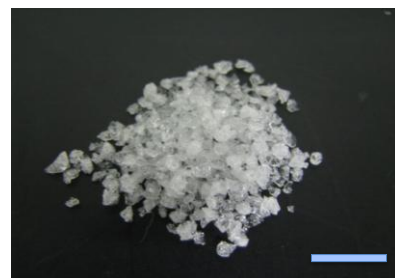
図 2 開発した多孔質シリカの外観写真 (ビーズ状)
